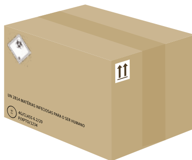
Fig. 1 — Rotulagem de embalagem de transporte de Matérias Infecciosas em condições “normais”.
